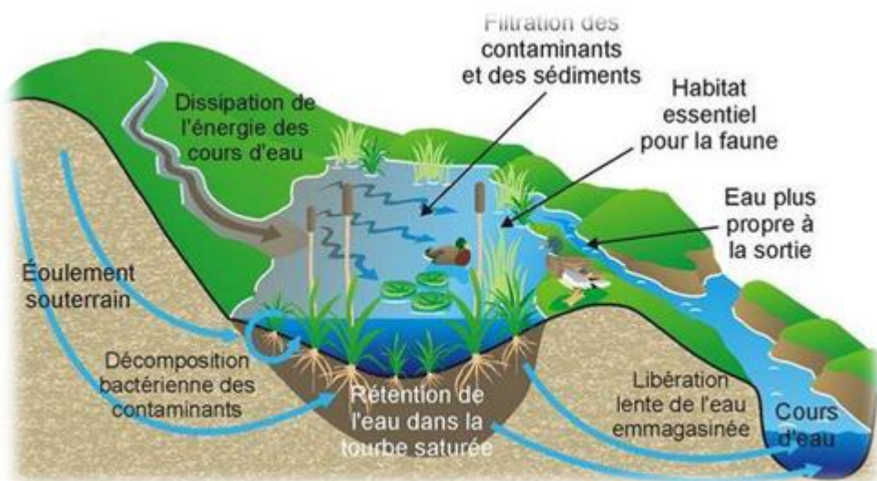
Schéma du fonctionnement d'une zone humide
